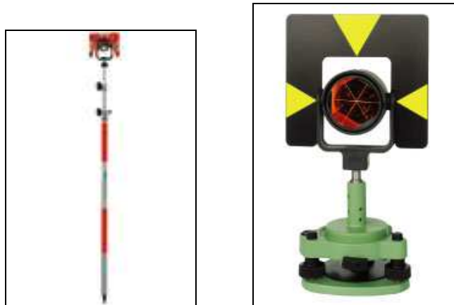
Εικόνα 3.5 Χρήση ανακλαστήρα με στυλεό ή τρικόχλιο
