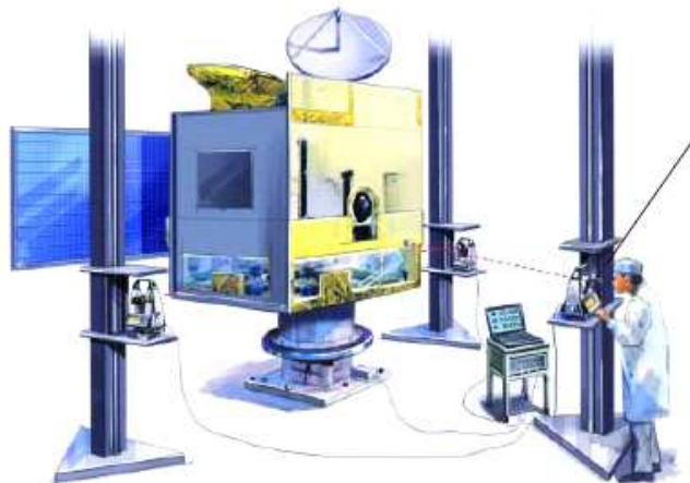
Εικόνα 6.1 Χρήση μεθόδου εμπροσθοτομίας σε εφαρμογές βιομηχανικής γεωδαισίας [13]
