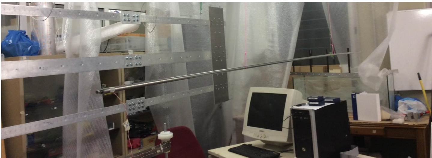
Εικόνα 1. Πειραματική διάταξη για την μέτρηση ταχύτητας ήχου σε ελαστικό μέσο και την διερεύνηση δυναμικής διαμήκων κυμάτων και ελεύθερων ταλαντώσεων σε ελαστική ράβδο.
