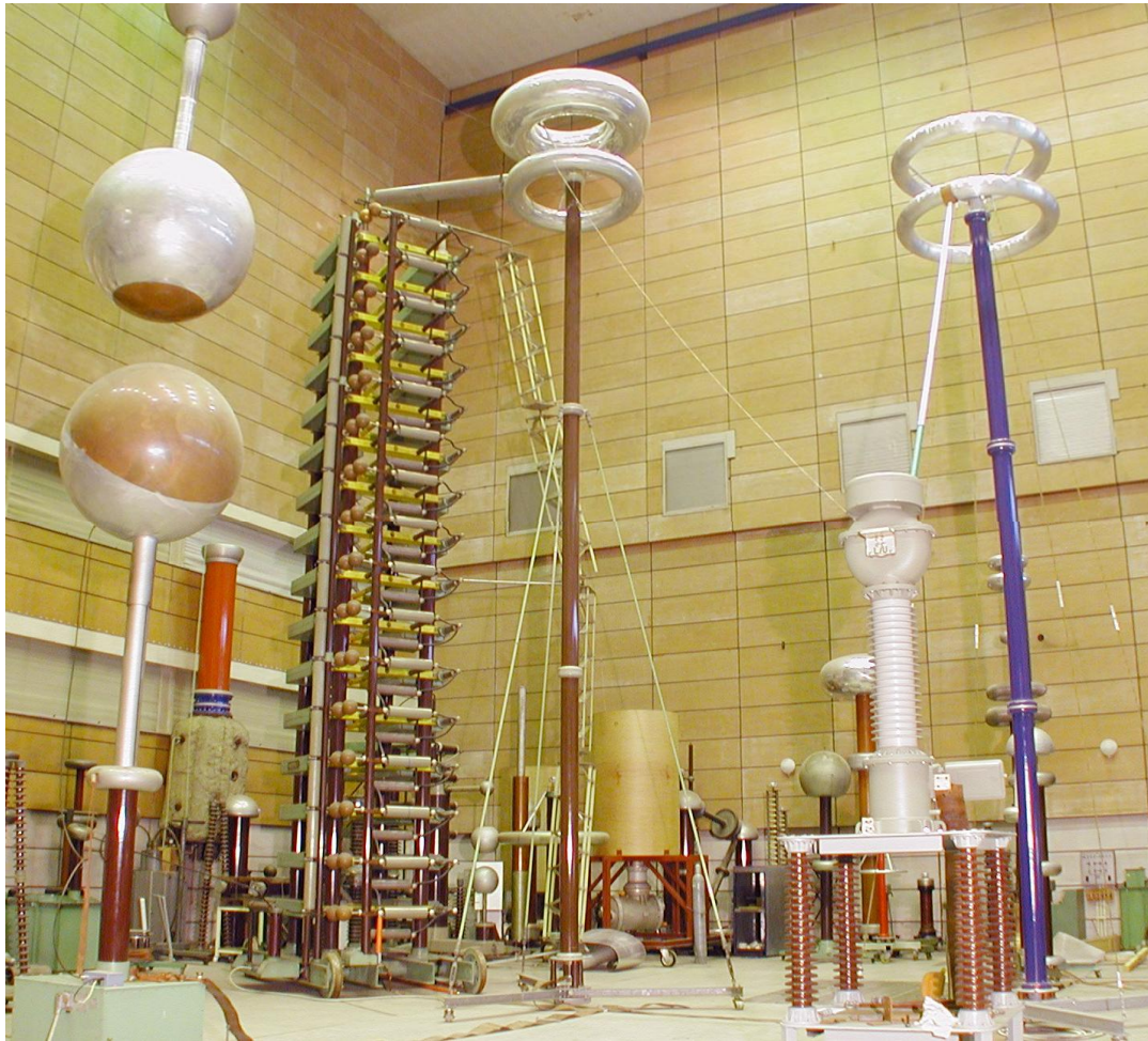
Σπινθηριστής μίας βαθμίδας για παραγωγή αποκεκομμένης κρουστικής τάσης
