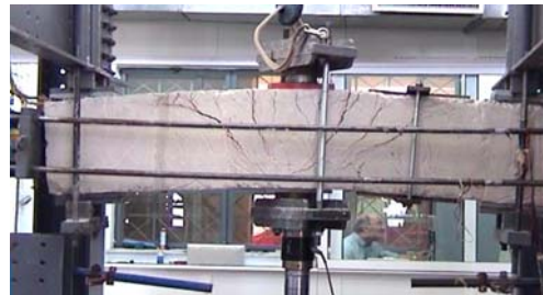
Εικόνα αστοχίας διατμητικά άοπλης δοκού με λόγο διάτμησης 2 (από Διπλωματική στο ΕΜΠ)
