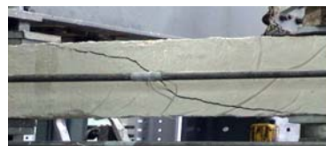
Εικόνα 1.1 (α) Πλάστιμη (καμπτική) αστοχία (β) Ψαθυρή (διατμητική) αστοχία
