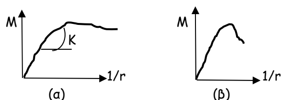
Σχ. 3.4 Διάγραμμα M-1/r για διατομή: (α) υπεροπλισμένη (β) υποοπλισμένη
