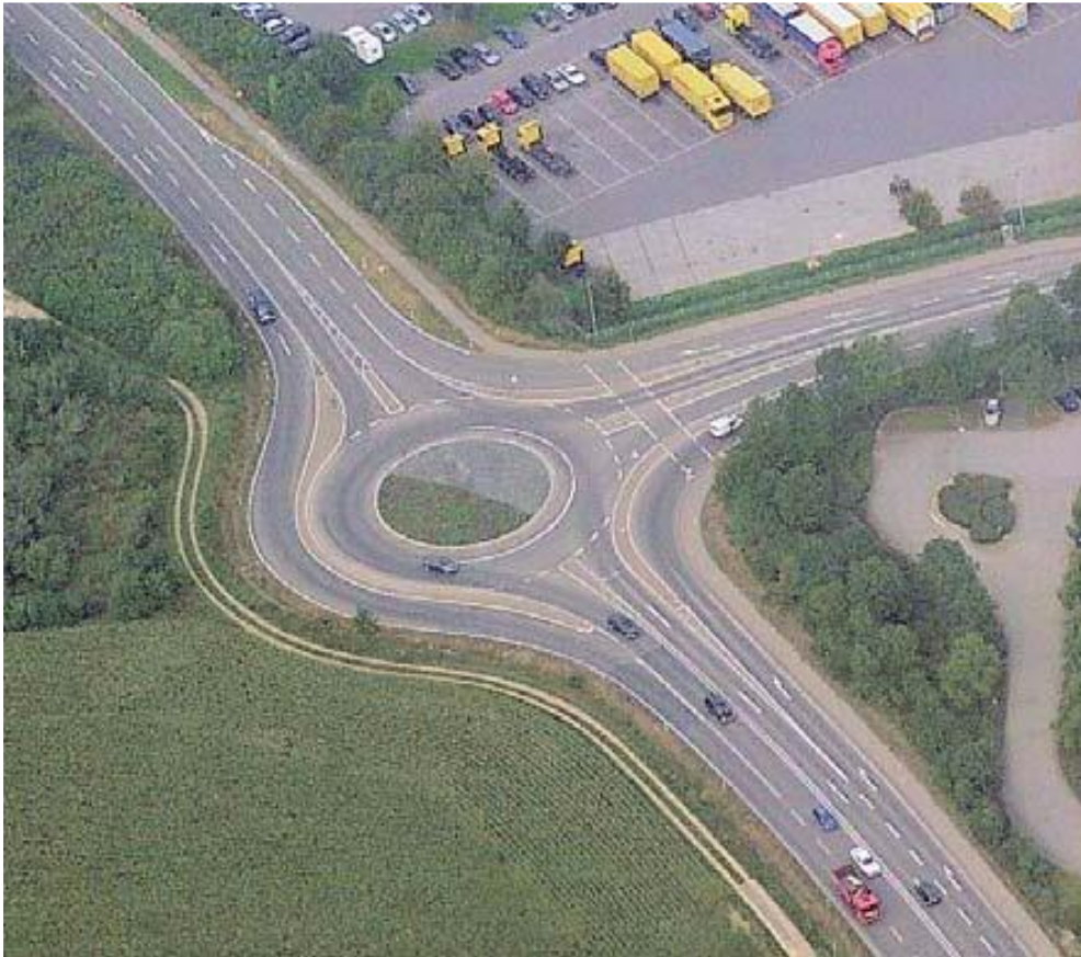
Σχήμα 5.29. Παρακαμπτήριες λωρίδες σε τρισκελή υπεραστικό κυκλικό κόμβο [31].
