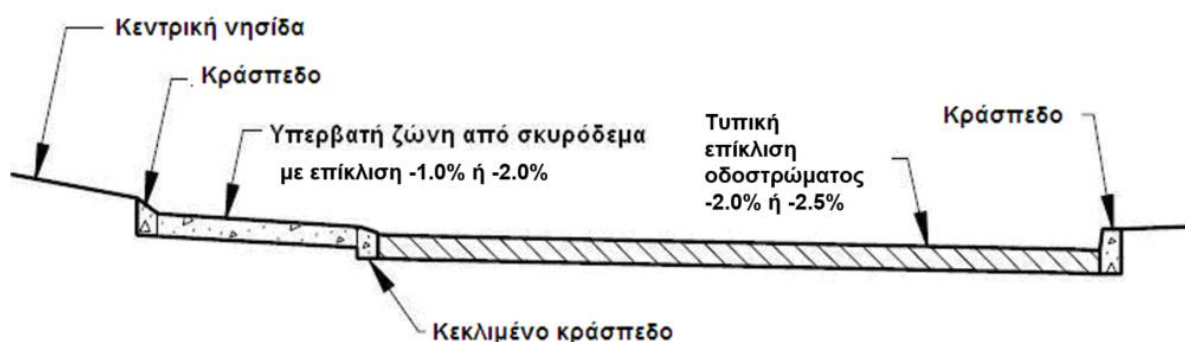
Σχήμα 5.22. Επικλίσεις επί του κυκλικού οδοστρώματος.
