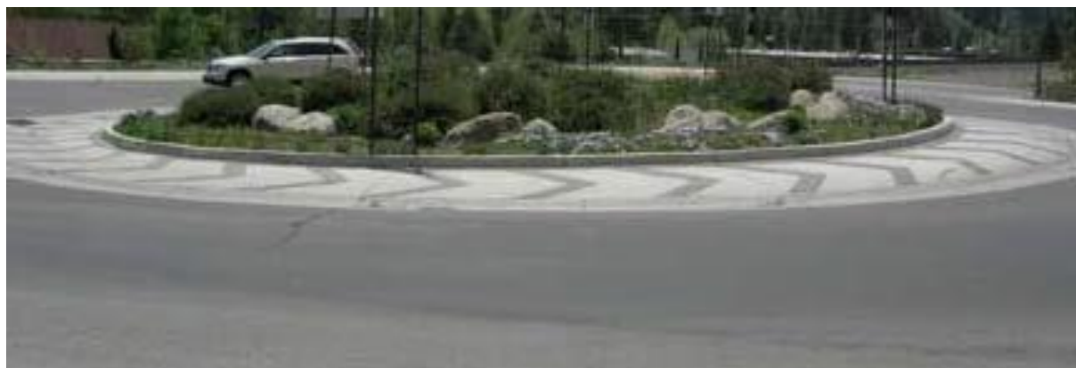
Σχήμα 5.23. Υπερβατή ζώνη σε κυκλικό κόμβο.
